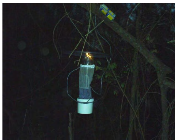
Figura 12. Detalhe da armadilha do tipo CDC a ser instalada nas áreas de influência da LT 500 kV Marimbondo II – Assis.
